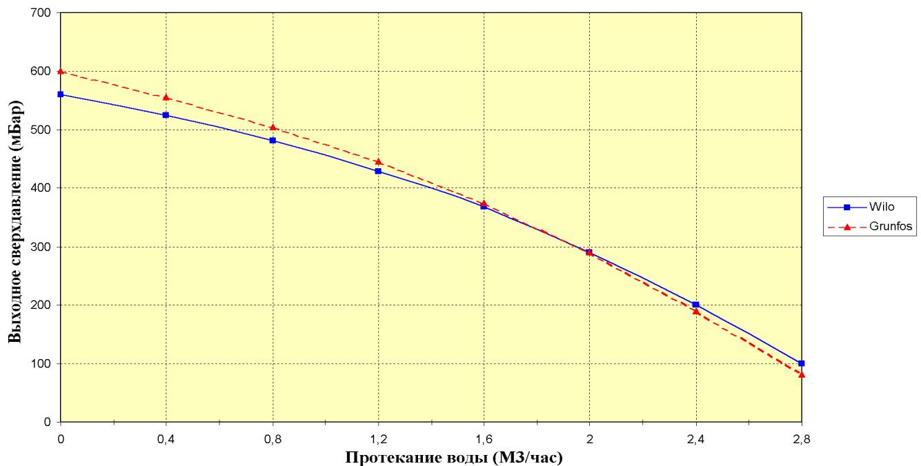
*Предупреждение: Кривые применимых присоединительных сверхдавлений воды отопления рассчитаны на насосы Wilo 25/70 и Grundfos 15/60 на максимальную степень регуляции. Учитывая производительность котла, не рекомендуем снижать мощность насоса*
